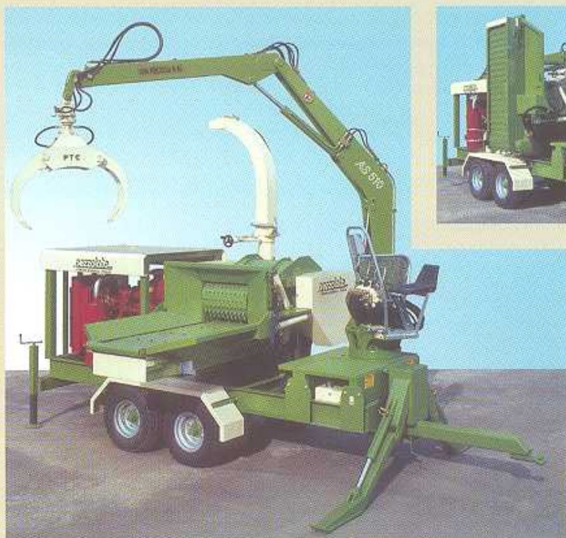
PTH 700/660 M en position de travail avec moteur autonome AIFO IVECO de 300 hp, chariot tandem pour basse vitesse, chargeur Dalla Bona avec flèche de 7 m
