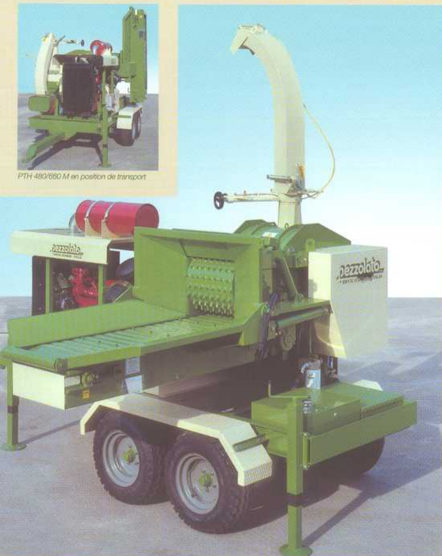
PTH 480/660 M en position de travail avec moteur autonome AIFO IVECO de 160 hp, chariot tandem pour basse vitesse
